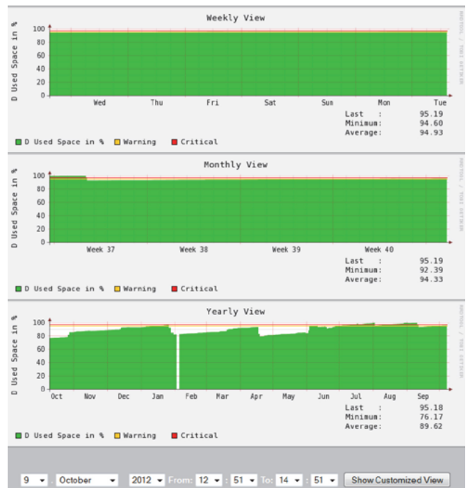
Die Abbildung zeigt den zeitlichen Verlauf der Plattennutzung in einem Speichersystem bei 2020. Die gelben und roten Linien zeigen jeweils das Warn- und Alarmlevel an. Je nach überwachtem Objekt werden ggf. unterschiedliche Administratoren alarmiert.
